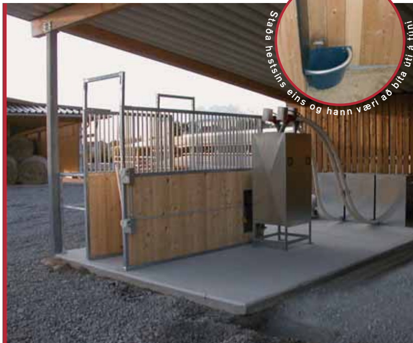
Horseking®-fóðurbætisstöðin K 30.0 ásamt sjálfvirkri áfyllingarkerfi
